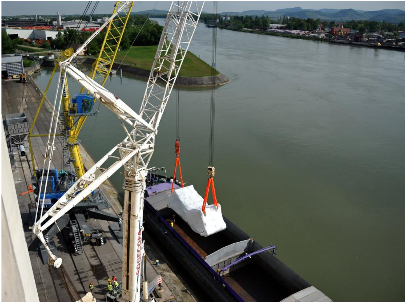
Opération délicate de levage par les deux grues pour le chargement de la tourelle de la grosse pelle minière dans la péniche. PHOTOS DNA - LAURENT HABERSETZER
