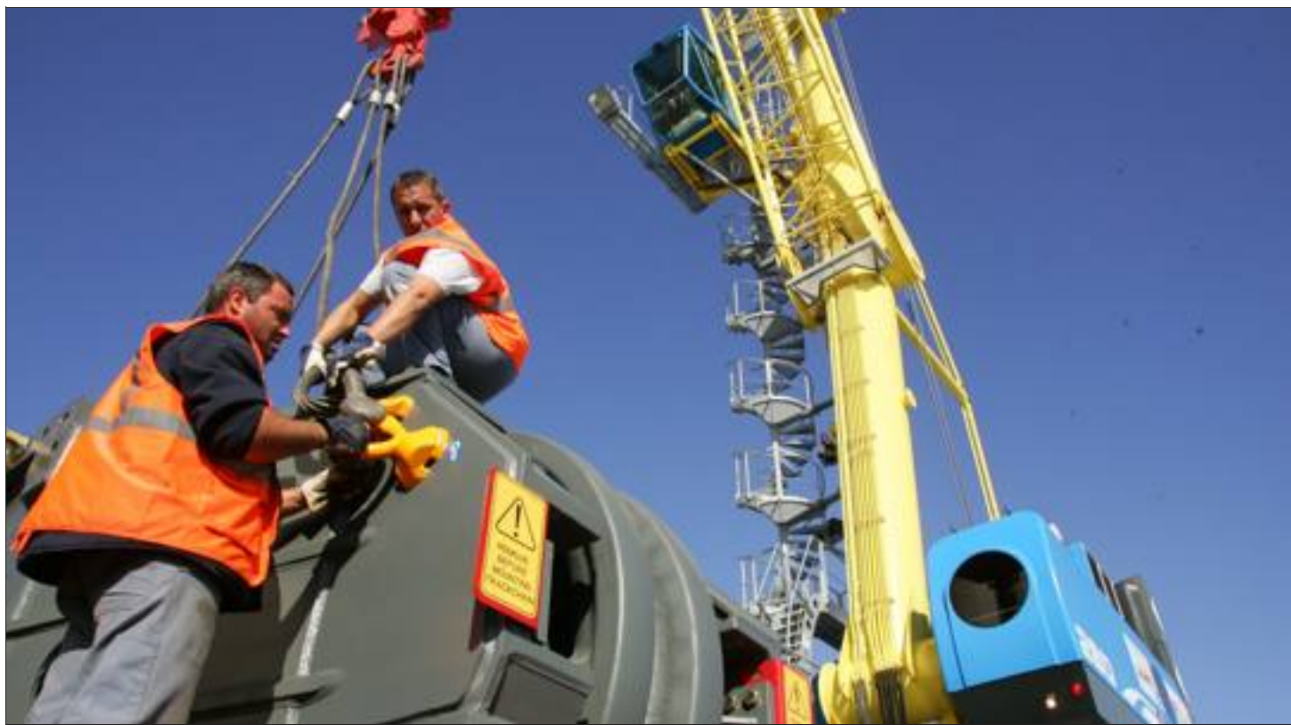
Cette grue Liebherr d'une capacité de 80 tonnes permet de manipuler cinq fois plus de marchandise en vrac.
